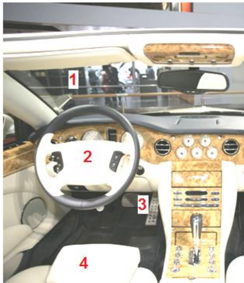
Figura 4.1 - Interior de um automóvel (Bentley Azure) com os meios de interação com o motorista: 1-Visão; 2-Volante; 3-Pedais; 4-Banco. Online. Disponível em <4car.net> Acessado em abril de 2012
