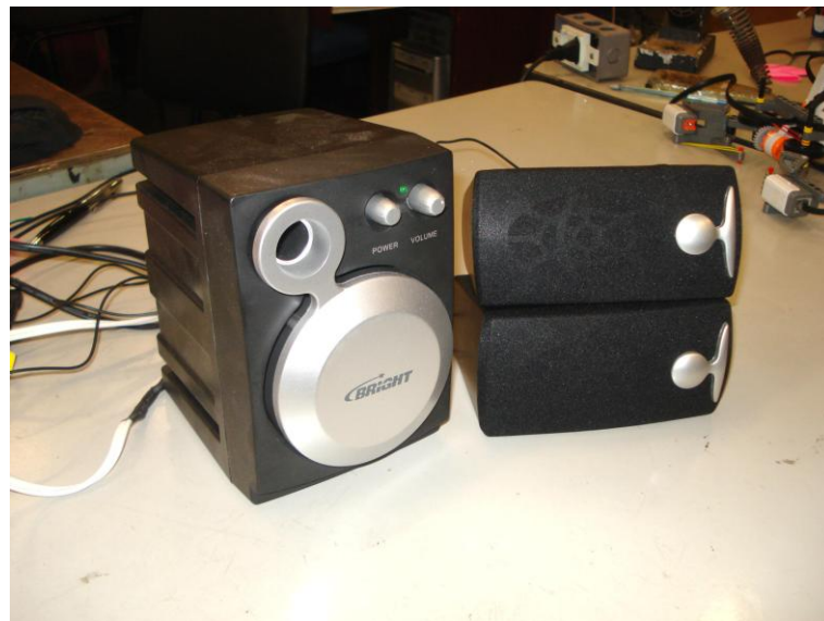
Figura 5.8 – Caixas de som Bright , 5W RMS, com SubWoofer .
