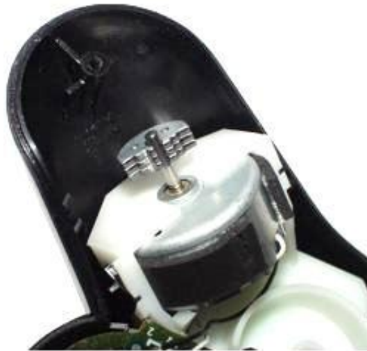
Figura 8.1 – Motor com carga desbalanceada que causa vibração presente em controle de vídeo-game. Online. Disponível em < http://produto.mercadolivre.com.br/MLB-436498181-motor-de-vibracao-do-controle-do-ps3-_JM?redirectedFromChild=MLB445779818 > Acessado em outubro de 2012.
